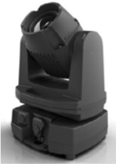
Moving Head mit weisser Custom-LED-Lichtquelle 6'500K, Netz- oder Akkubetrieb (10-12 Stunden Betriebszeit), sehr enger Abstrahlwinkel von nur 2.8°, völlig kabellos mit Wireless DMX, wetterfest, staubdicht, wartungsfrei, Schutzklasse IP65.
